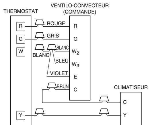
Figure 9 – Agencement du câblage – Climatiseur (climatisation seulement)
