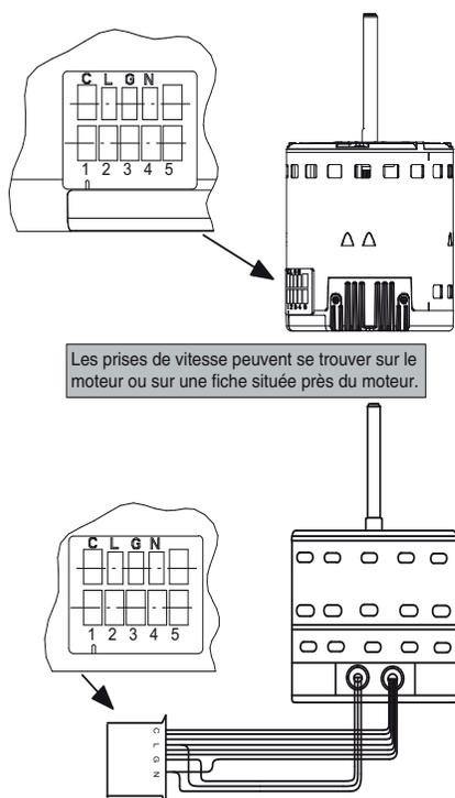
Figure 14 – Sélection de vitesse du moteur
