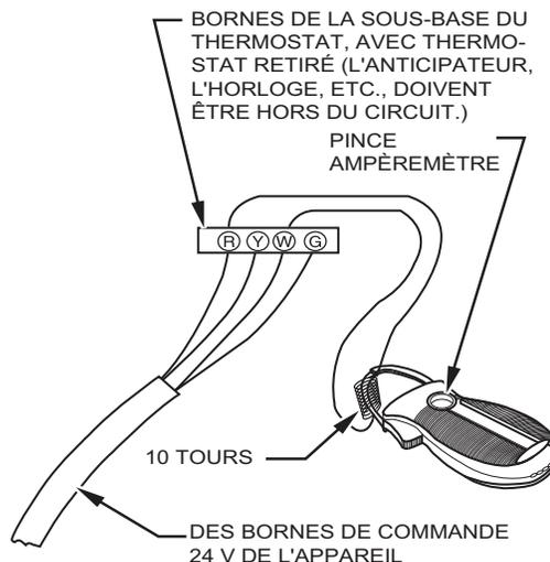
EXEMPLE :  $\frac{5,0 \text{ A SUR L'AMPÈREMÈTRE}}{10 \text{ TOURS AUTOUR DES MÂCHOIRES}} = 0,5 \text{ A POUR LE THERMOSTAT RÉGLAGE DE L'ANTICIPATEUR}$
