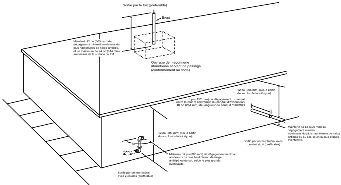
Figure 126 – Sortie d'évent pour système à ventilation non directe et à air de combustion ventilé
