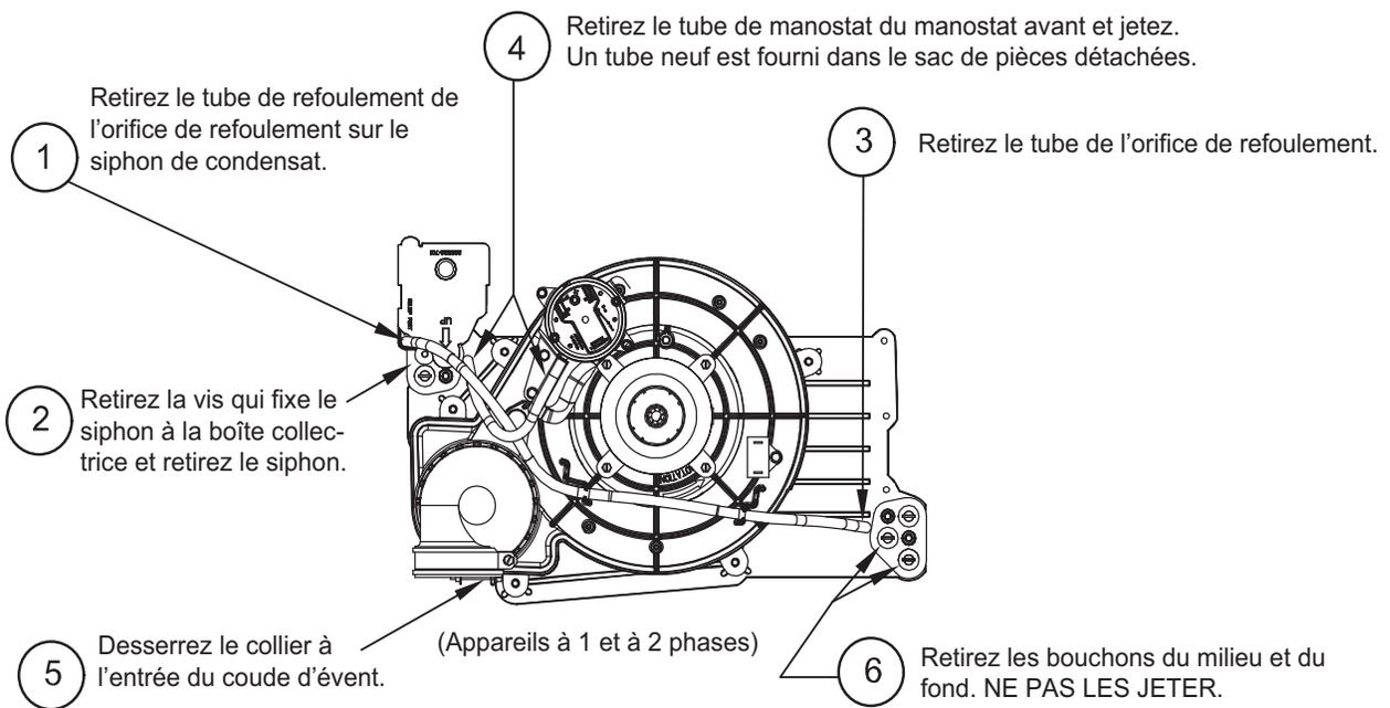
**Configuration non convertie en usine telle que vue dans l'orientation à tirage descendant**
