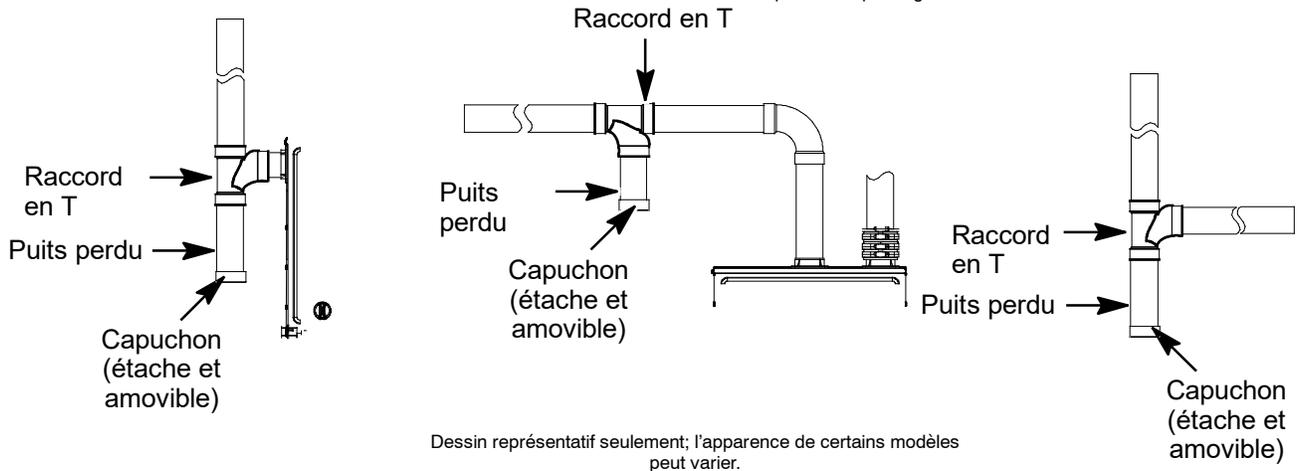
**Figure 111 – Siphon de condensat d'air de combustion recommandé**
