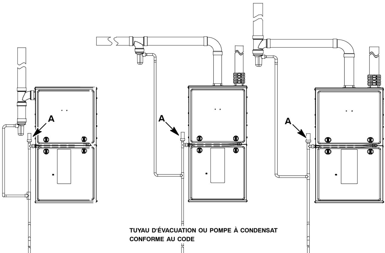
Il est recommandé d'utiliser un raccord en T avec conduit vertical (A) d'une hauteur minimale de 4 po (102 mm) du même diamètre ou d'un diamètre supérieur se prolongeant vers le haut.
