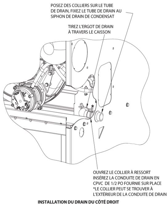
**Figure 86 – Œillet d'évacuation de condensat formé en caoutchouc**
