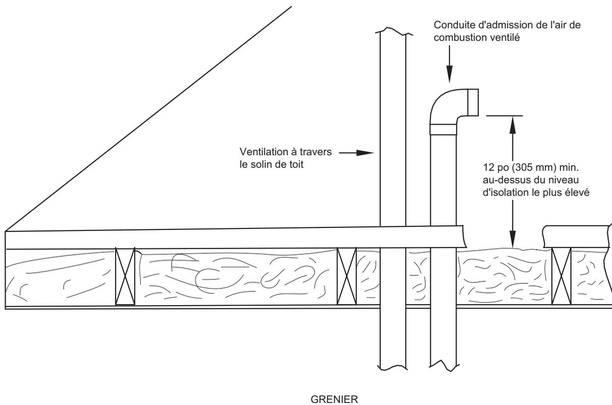
Figure 128 – Sorties d'évent pour système à air de combustion ventilé
