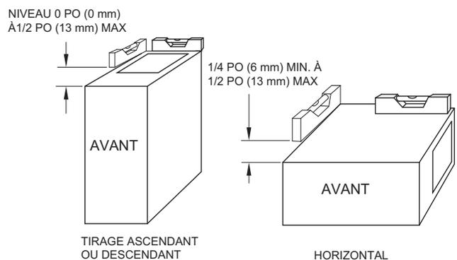
Figure 93 – Exigences d'inclinaison de la chaudière
