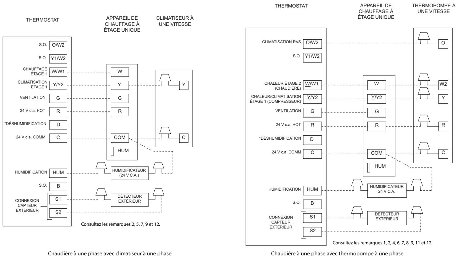
Figure 109 – Schémas de câblage de thermostat
