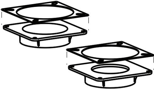
Fixez les joints aux adaptateurs de tuyaux d'évent et d'air de combustion.
