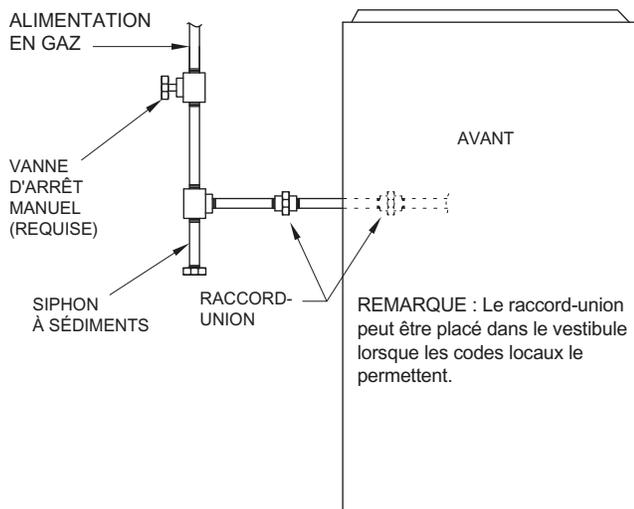
Figure 104 – Disposition type de la tuyauterie de gaz
