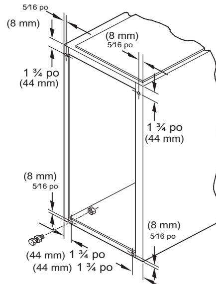
Figure 92 – Pattes de mise à niveau
