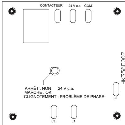
Figure 10 – Commande de moniteur triphasé
